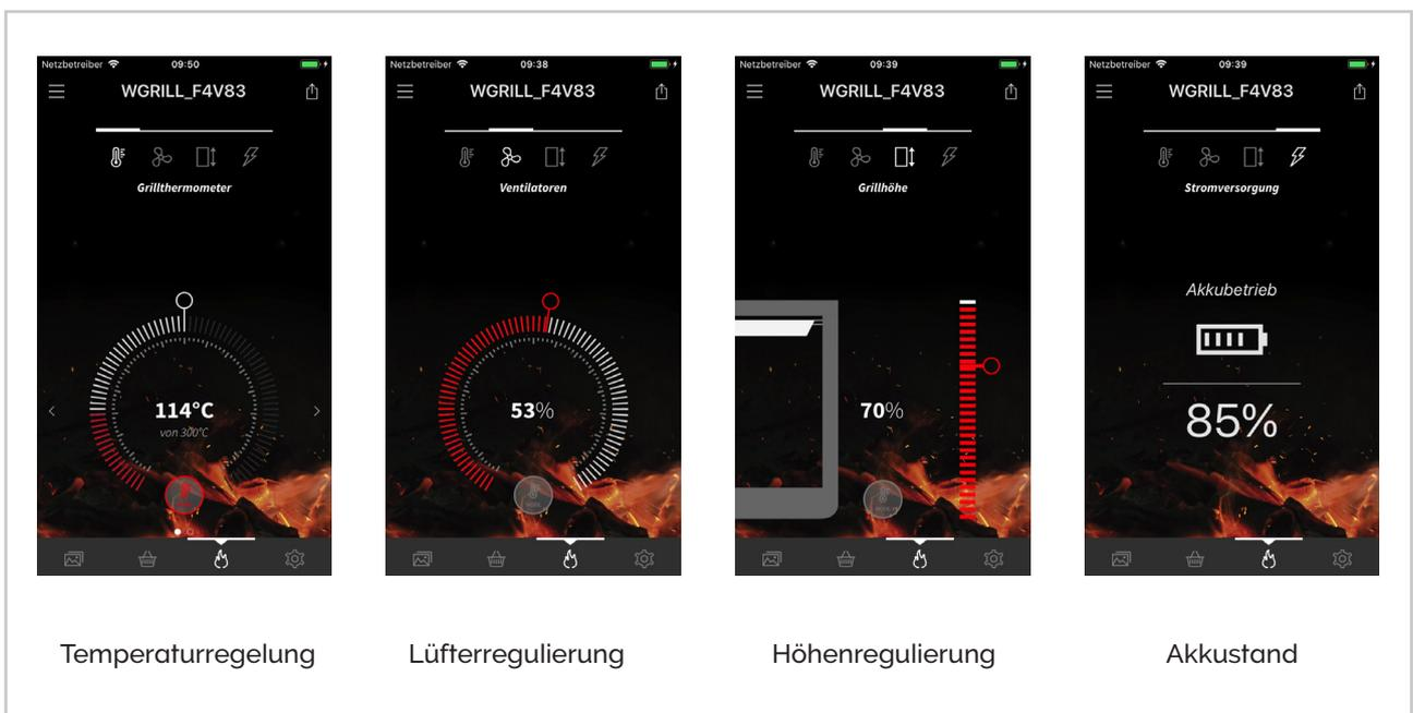
Bild 4: Aufbau der Grillsteuerung
