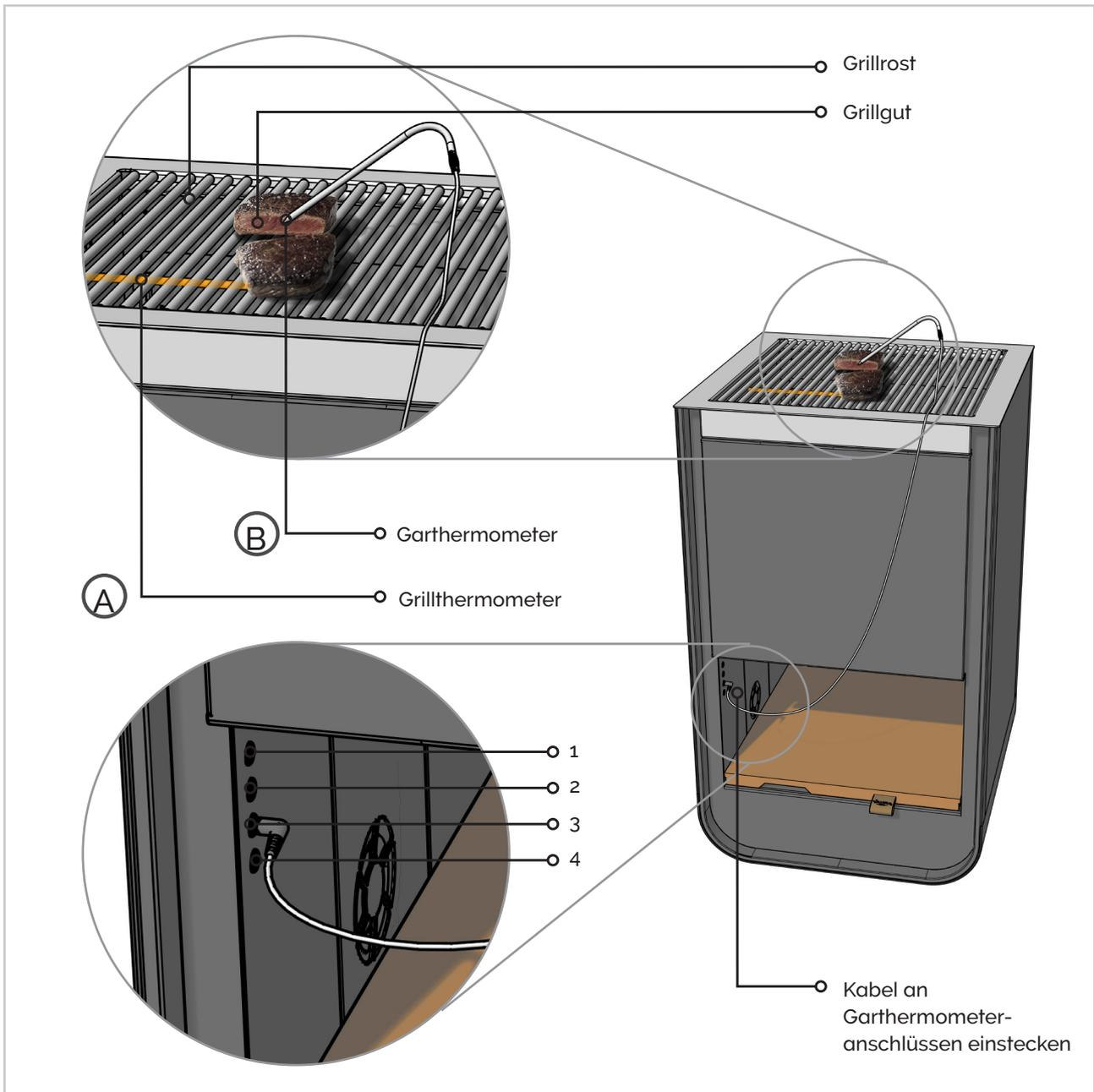
Bild 5: Schnittdarstellung am Grillrost mit Position der Temperatursensoren
